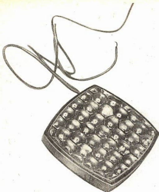
Fig. 9 - Esempio di cellula solare al selenio, di attuale produzione e già montata in contenitore di plastica. Si tratta del modello B3M.
